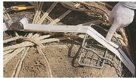
根鉢の角(カド)に、しっかり当たっていることを確認し、指し示す部分が浮かなくなるまで、ウィンチで締め付ける。
