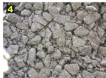
転圧を加えた後のパワーミックスの状態。根の伸長できる適度なすき間が見える。
