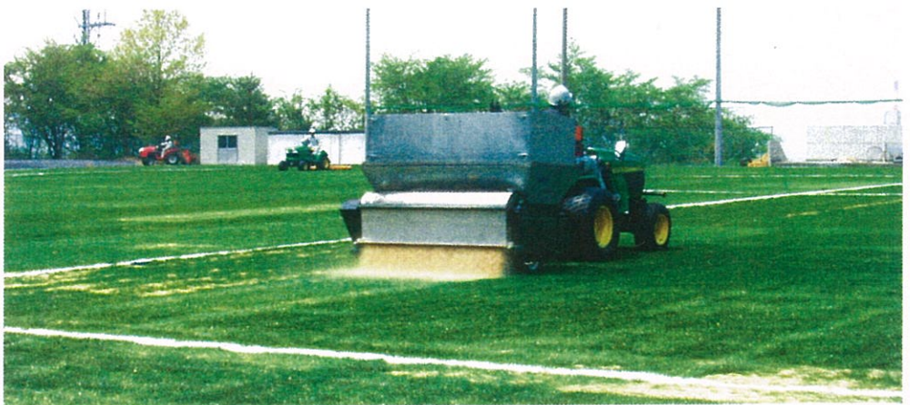
サッカー場目土砂散布
