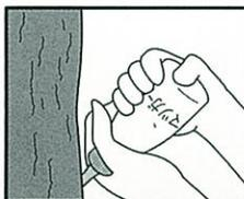
容器の底にある空気抜き穴に、所定の針を刺し空気穴を開けて下さい。
